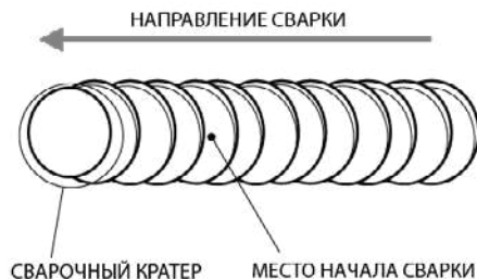
Рис. 10.4. Начало сварки при смене электрода.
