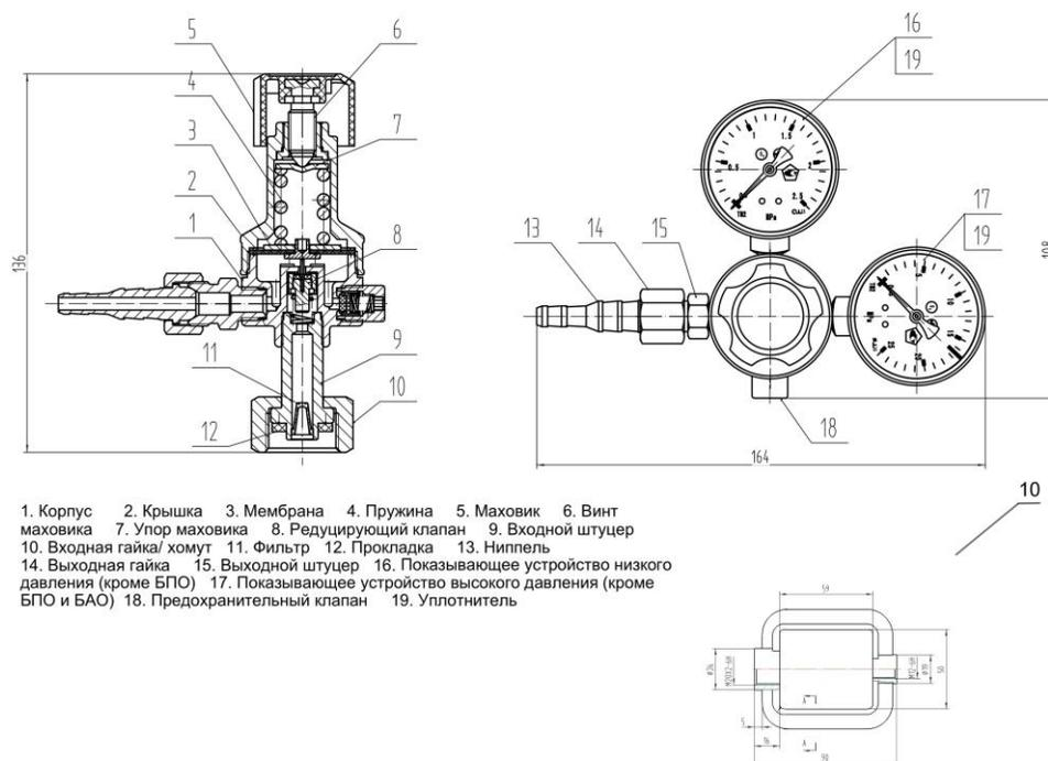
Рис. 1. Редуктор баллонный одноступенчатый.
