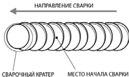
Рис. 13.5. Начало сварки при смене электрода.
