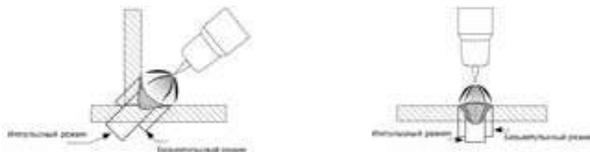
Рис. 8.10. Выделяемое тепло в импульсном и безимпульсном режимах.
