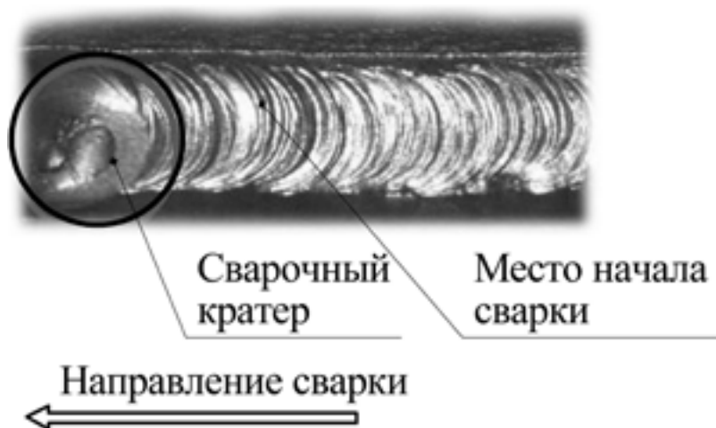
Рис. 9.4. Начало сварки при смене электрода.
