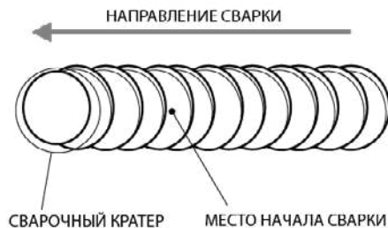
Рис. 10.4. Начало сварки при смене электрода.
