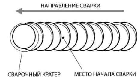
Рис. 9.4. Начало сварки при смене электрода.
