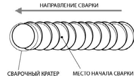
Рис. 9.4. Начало сварки при смене электрода.
