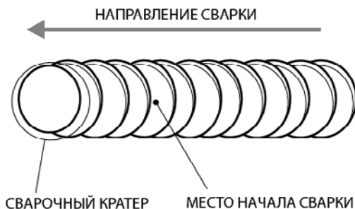
Рис. 11.4. Начало сварки при смене электрода.
