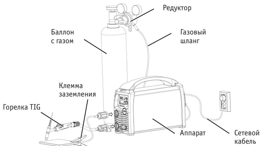
Рис. 8.1. Схема подключения оборудования.
