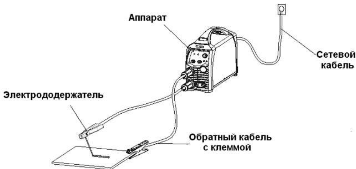
Рисунок 6.3 Схема подключения оборудования для ММА сварки.
