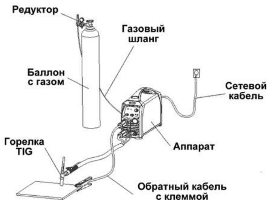
Рис. 6.2 Схема подключения оборудования для TIG сварки
