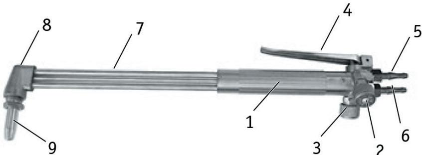
Газосмесительный мундштук разборный, состоит из двух частей. Внутренняя часть представляет собой пятиканальный смеситель, сопрягающийся с головкой по трем коническим пояскам с углом  $30^\circ$ , и внутренний мундштук с каналом режущего кислорода и шлицами, образующими с наружным мундштуком каналы для выхода горючей смеси.
