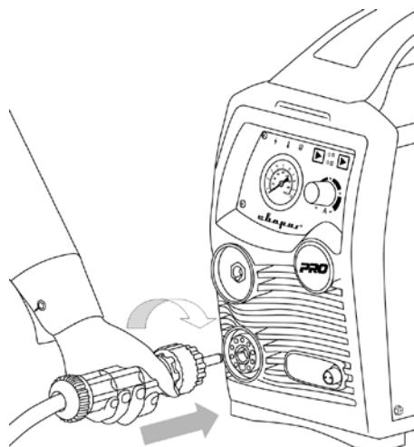
Рис. 8.4. Фиксация разъёма.
