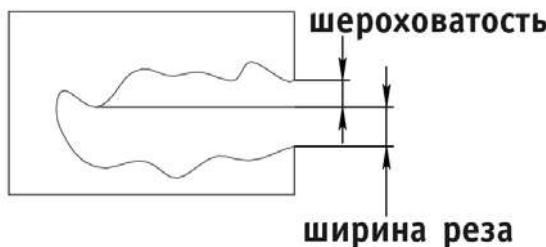
Таблица 11.3. Допуски на шероховатость поверхности.
