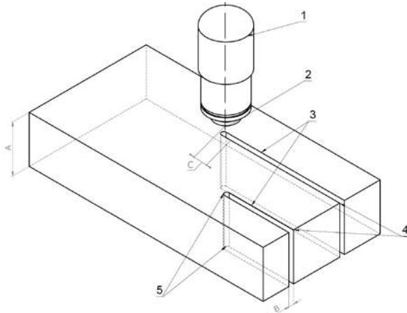
Рис. 11.1. Определения при резке под углом  $90^\circ$ .
