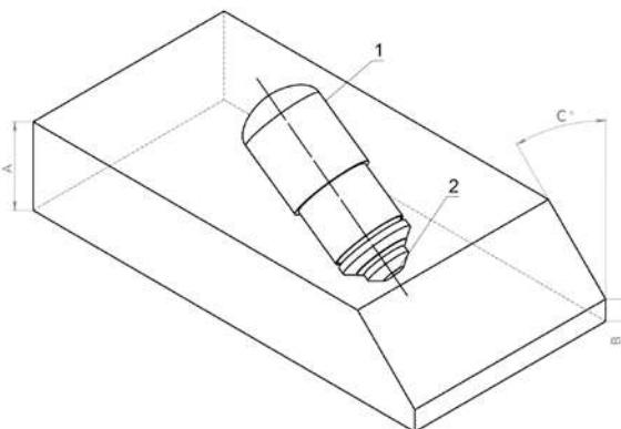
Рис. 11.2. Определения при резке под углом менее  $90^\circ$ .
