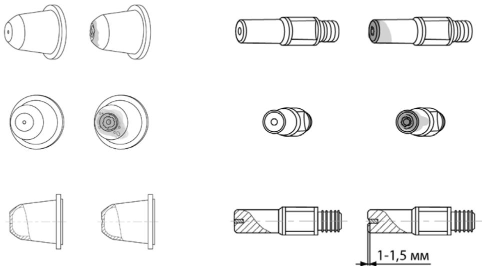
Рис. 9.8. Износ сопла (слева) и катода (справа).
