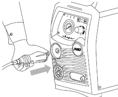
Рис. 8.3. Подключение клеммы заземления.
