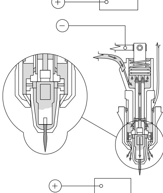
При контакте дежурной дуги с разрезаемой заготовкой подается рабочее напряжение и образуется рабочая дуга. После этого можно производить раскрой металла.
