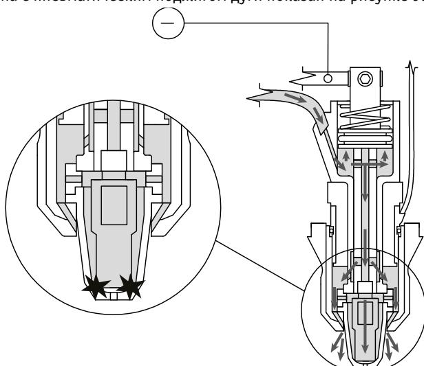
Сжатый воздух ионизируется и образуется дежурная дуга. Также происходит охлаждение головки плазмотрона.
