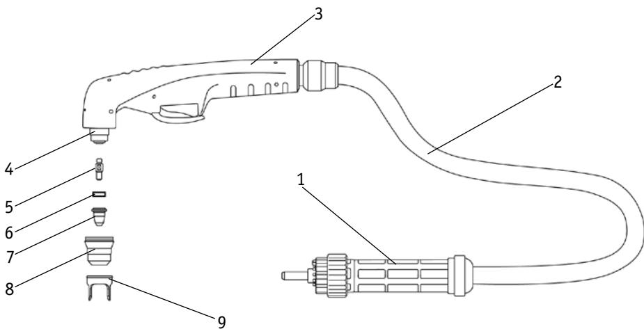
Рис. 9.3. Схема плазмотрона.
