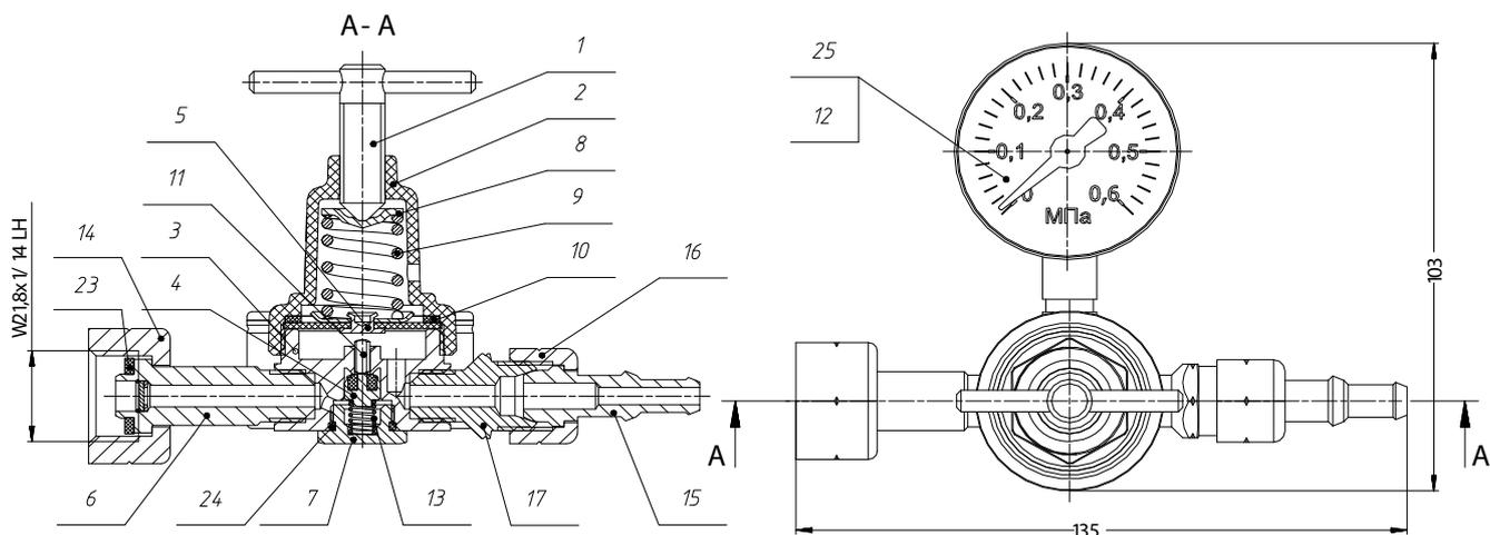
**Рис. 1. Редуктор баллонный пропановый одноступенчатый**
